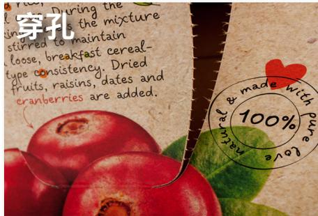
800 W 峰值功率可以更有效地提供能量，增加穿孔或钻孔速度并减少 HAZ；提供自动包装生产线上激光整理工艺的可靠解决方案。
